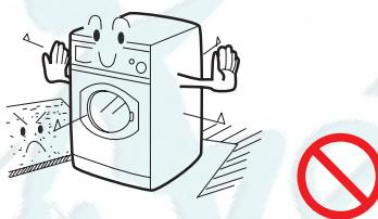
11. При установке проследите, чтобы шнур питания не был передавлен стиральной машиной, иначе он может быть поврежден.
